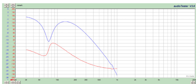
Rysunek 7. Charakterystyka amplitudowo-częstotliwościowa (kolor niebieski) oraz fazowo-częstotliwościowa (kolor czerwony) układu żyratora z filtrem dolnoprzepustowym
